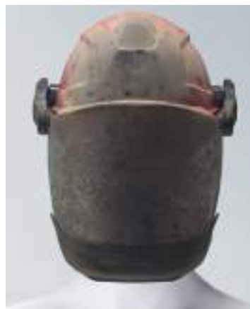
Po zásahu rušivým elektrickým oblúkom 7 kA
